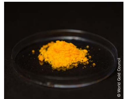
Goldsalz ist eines von wenigen Industrieprodukten aus Gold. Es entsteht durch Auflösung von Gold in Königswasser.
